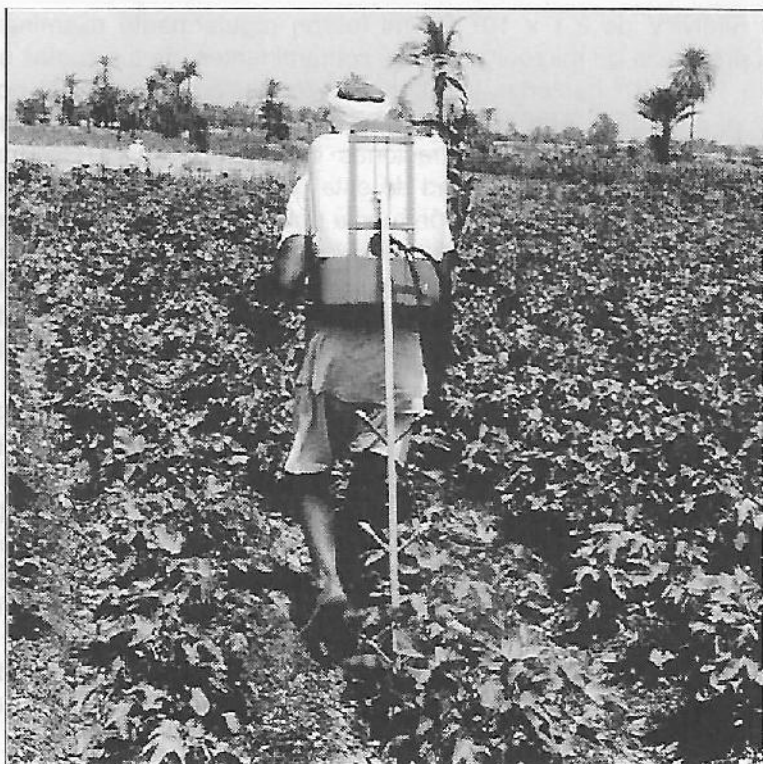
Figura 2. Bomba mochila pulverizadora modificada con boquillas apuntando hacia arriba para dirigir la pulverización a las áreas interiores de las hojas del algodón (foto cortesía del NRI, Chatham, Reino Unido).
